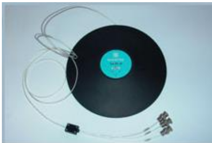
Rys. 4. Poduszka pomiarowa wykorzystana w badaniach Fig. 4. The pad measuring used in research
