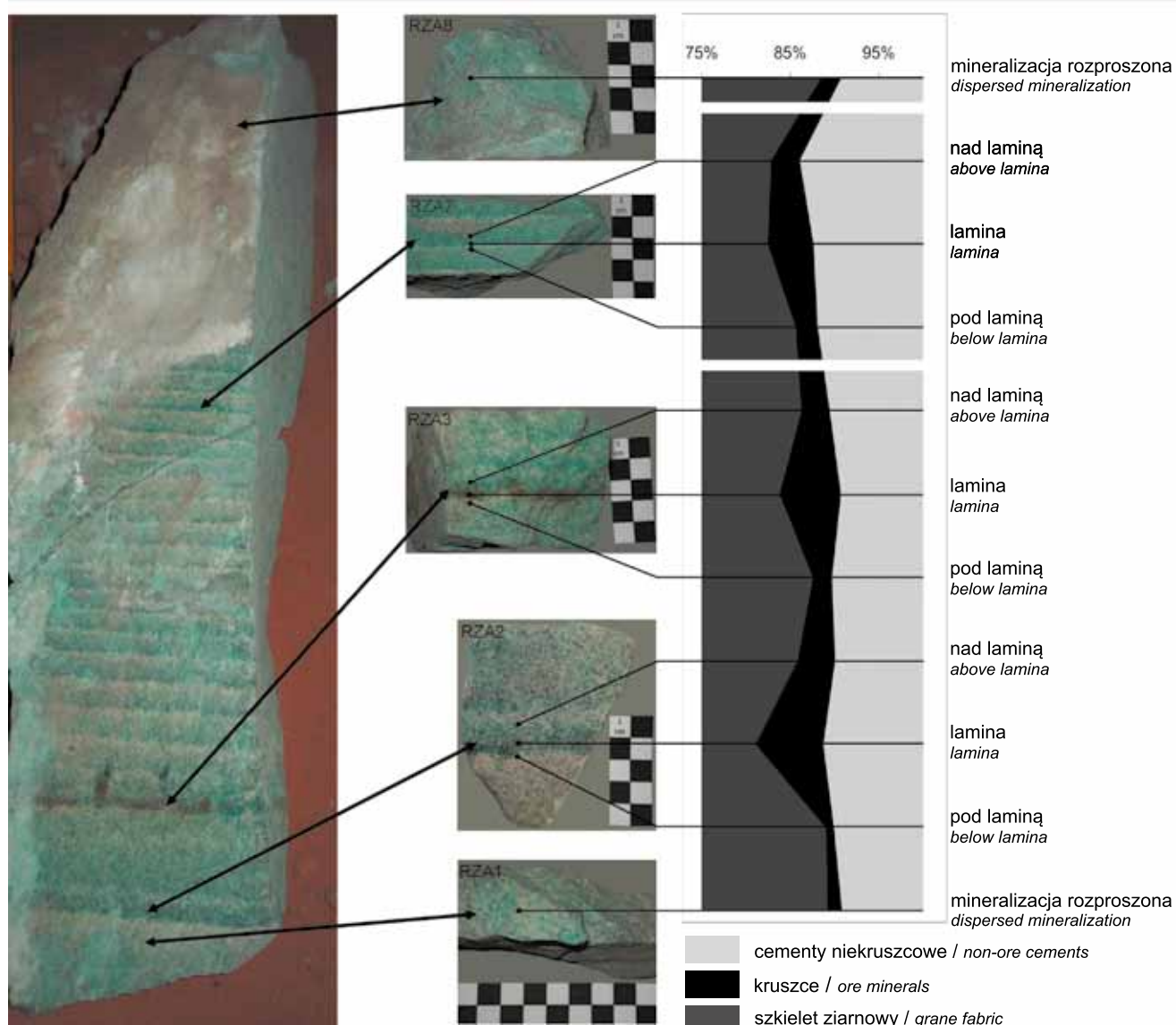
Fig. 5. Wyniki planimetrowania (szkielet ziarnowy, kruszce i spoiwa niekruszcowe) próbek (z uwzględnieniem lamin) z profilu RZA (Rudna Zachodnia)
