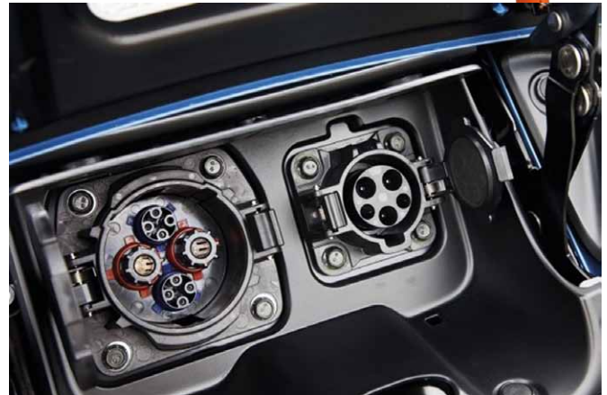
Rys. 3. Złącza zasilające w samochodach osobowych
