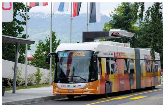
Rys. 5. System szybkiego ładowania baterii autobusu [2]
