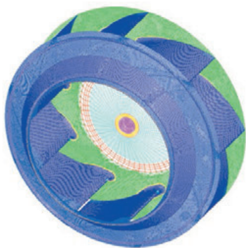
Rys. 2. Modele obliczeniowe wirnika: a) model zbudowany z elementów powłokowych, b) model 1/9 wirnika zbudowany z elementów objętościowych
