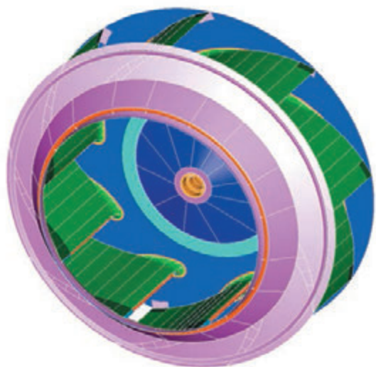
Rys. 1. Model dziewięciopatkowego wirnika WPK-5,3
