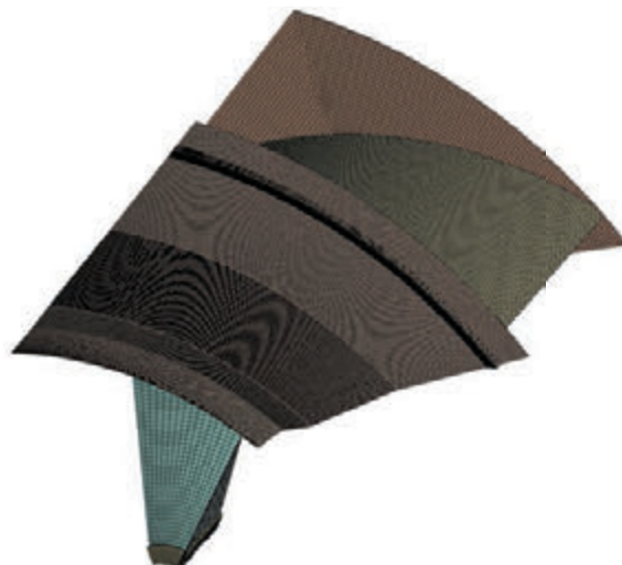
Rys. 2. Modele obliczeniowe wirnika: a) model zbudowany z elementów powłokowych, b) model 1/9 wirnika zbudowany z elementów objętościowych
