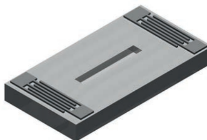
Rys. 3. Mikrokanal wycięty w warstwie materiału piezoelektrycznego ( \text{LiNbO}_3 ) [19].
