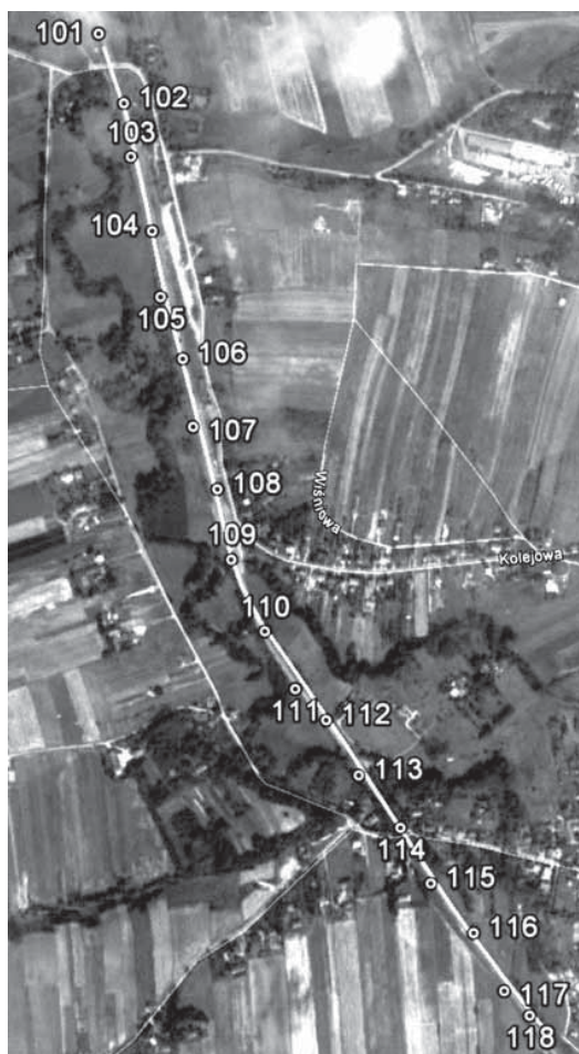
Rys. 5. Odcinek testowy w Słomnikach z oznaczonymi punktami osnowy geodezyjnej
