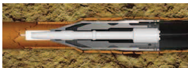
Rys. 25. Wciąganie głowicy kruszącej wraz nowym rurociągiem o większej średnicy do istniejącego rurociągu o mniejszej średnicy [20]
