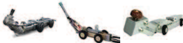
Rys. 7. Przykłady robotów kanalizacyjnych z różnymi rodzajami głowic [20]
