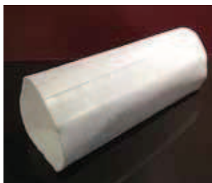
Rys. 9. Przykład rękawa przed jego nasączeniem żywicą [20]
