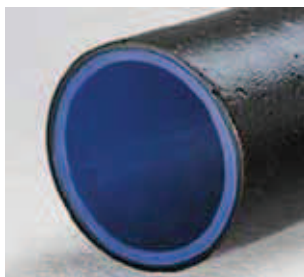
Rys. 17. Rura renowacyjna po rewersji i utwardzeniu w rurociągu poddawane renowacji [17]
