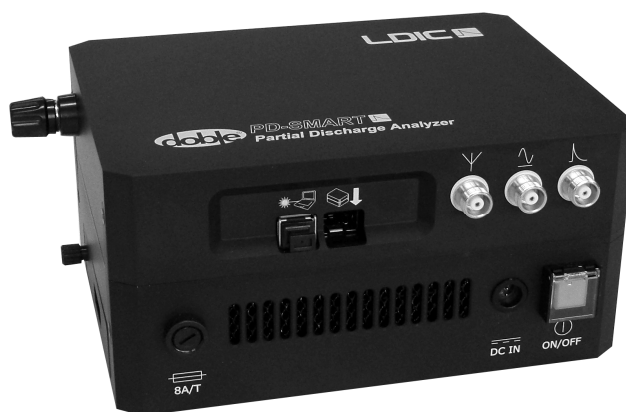
Rys. 1. Miernik PD Smart, służący do badania wnz metodą konwencjonalną [5]
