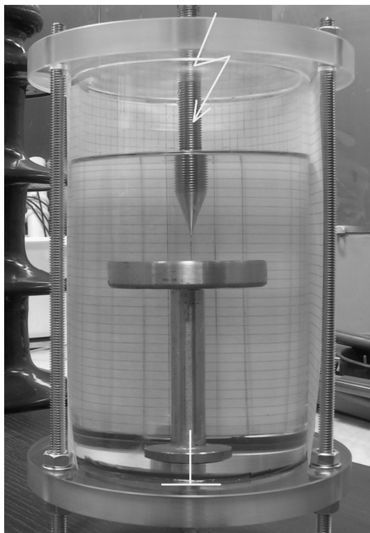
Rys. 4. Obiekt badany; cylinder z układem ostrze- płyta wypełniony olejem mineralnym
