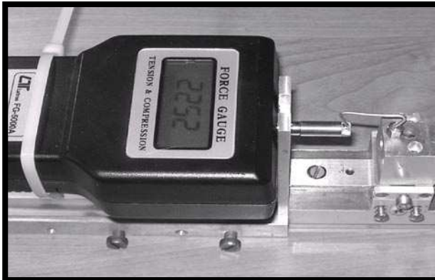
FIG. 5. Pomiar siły kompresji klamry z pamięcią kształtu przy użyciu cyfrowego miernika siły. FIG. 5. Measurement of compression force of a shape memory staple by using a digital force gauge.
