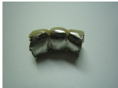
Rys. 2. Część „mostu protetycznego”, przeznaczona do badań i opisana jako – stal 1
