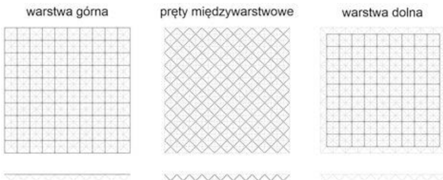
Rys. 5. Podział prętów na grupy Fig. 5. The division of the rods to the group
