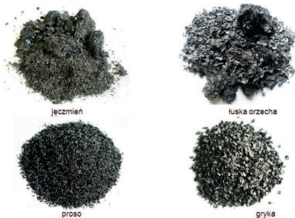
Rys. 6. Wyniki obróbki termicznej w temp. 800°C wybranych odpadów z przemysłu spożywczego Fig. 6. Results of heat treatment at 800°C for selected wastes from the food processing industry
