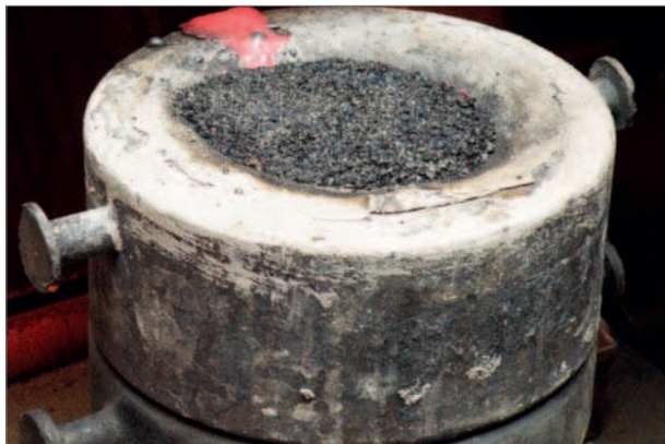
Rys. 8. Głowa wlewka pokryta zasypką izolacyjną opracowaną na bazie krajowych odpadów zbożowych
