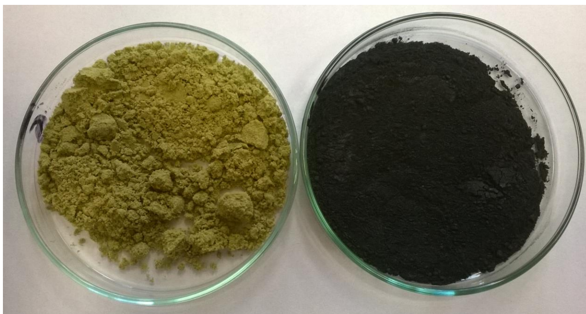
Rys. 4.3 Z lewej strony odpad na bazie \text{FeSO}_4 , z prawej strony czarny pigment na bazie \text{Fe}_3\text{O}_4 (M.Chyc)
