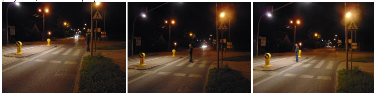
Rys. 4. Przejście dla pieszych oświetlone z wertykalnie - przy krawężniku, w \frac{1}{4} i w \frac{1}{2} przejścia [opracowanie własne]
