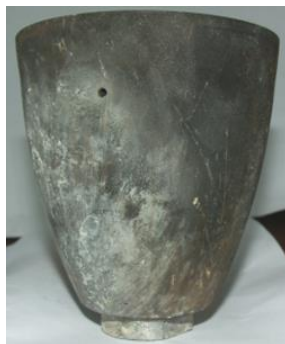
Fot. 2. Czepiec balistyczny po rozcaleniu statycznym z zaślepką (opracowanie własne)
