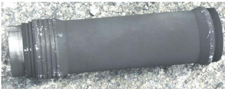
Fot. 3. Korpus z zablokowaną tuleją osłonową ładunku dymnego po rozcaleniu statycznym (opracowanie własne)
