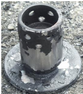
Fot. 1. Zespół zapalająco-wyrzucający po próbie (opracowanie własne)
