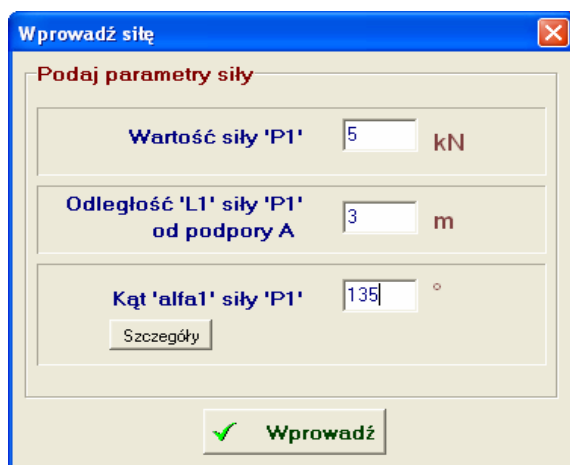
Rys. 3. Okno wprowadzania obciążenia w postaci siły (klawisz Szczegóły wywołuje komunikat precyzujący pojęcie kąta nachylenia siły do osi belki)
