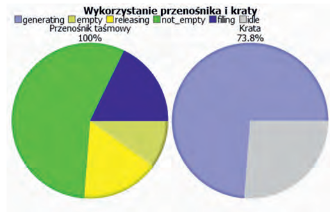
Rys. 7. Wykresy kołowe pracy przenośnika taśmowego i kraty załadowniczej. Generating – czas przesypania urobku przez kratę, empty – czas pracy, kiedy przenośnik jest pusty, releasing – odpływ urobku z przenośnika większy niż napływ, not_empty – napływ i odpływ urobku z przenośnika jest równy, filling – napływ urobku na przenośnik większy niż odpływ, idle – praca jałowa kraty Fig. 7. Pie charts of conveyor belt and grate operations
