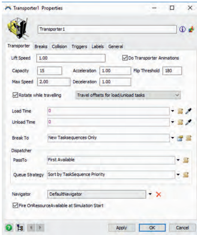
Rys. 4. Parametry wozu odstawczego Fig. 4. Parameters of a haul truck
