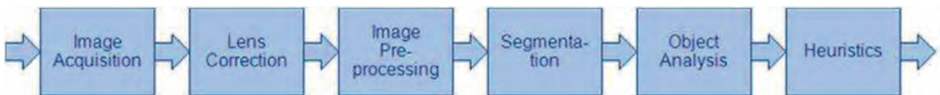
Fig. 9. The typical computer vision pipeline (Embedded Vision Alliance, 2016) Rys. 9. Typowy przykład przetwarzania potokowego (Embedded Vision Alliance, 2016)
