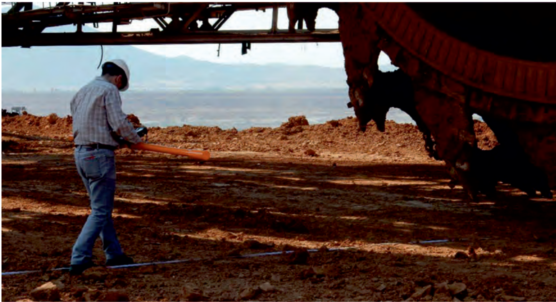
Fig. 5. Field test to determine the influence of the BWEs steel structure on the measured apparent conductivity Rys. 5. Badanie terenowe w celu określenia oddziaływania stalowej budowy koparki na zmierzoną przewodność pozorną.
