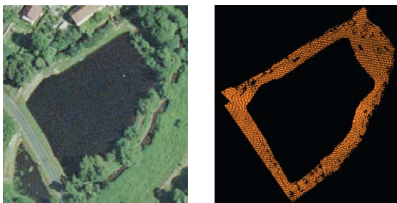
Rys. 3. Obiekt testowy ob8 (vide tab. 1): ortofotomapa (po lewej) i punkty klasy grunt chmury punktów lotniczego skaningu laserowego (po prawej)
