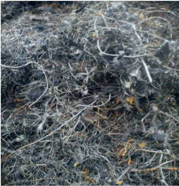
Rys. 3. Zanieczyszczony kord metalowy przed etapem końcowym jego recyklingu – „doczyszczanie” drutów
