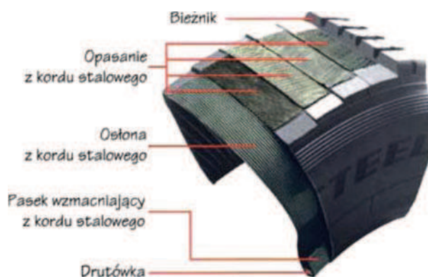
Rys. 2. Przekrój przez oponę całostalową do samochodów ciężarowych [5]
