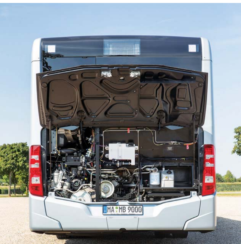
Pierwotnym źródłem energii w hybrydowej wersji Citaro jest silnik OM 936 LA o pojemności 7,7 dm 3
