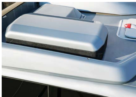
Oslona baterii superkondensatorów, zapewniająca odpowiednie temperatury pracy
