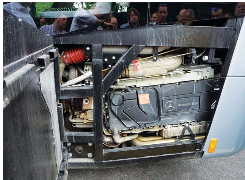
Dodatkowy silnik elektryczny został zamontowany pomiędzy silnikiem spalinowym a skrzynią biegów
