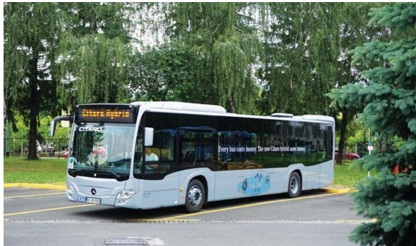
Napęd hybrydowy oferowany jest jako opcjonalne wyposażenie niemal każdego modelu Citaro C2
