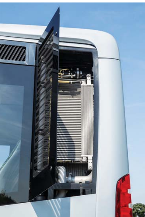
Chłodnica silnika elektrycznego i falownika
