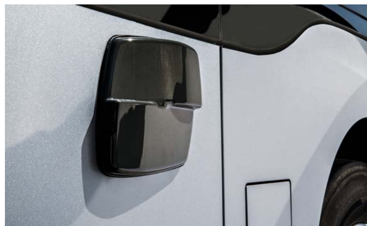
Czujniki radarowe systemu Side Guard Assist. Fot. Daimler
