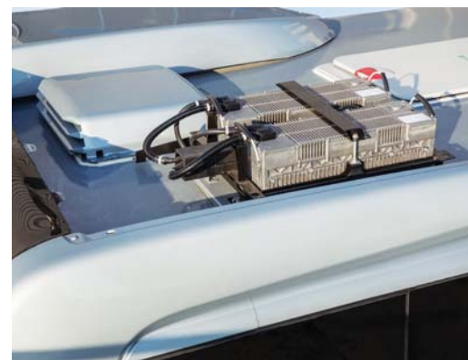
Kondensatory zostały zamontowane na dachu w tylnej jego części
