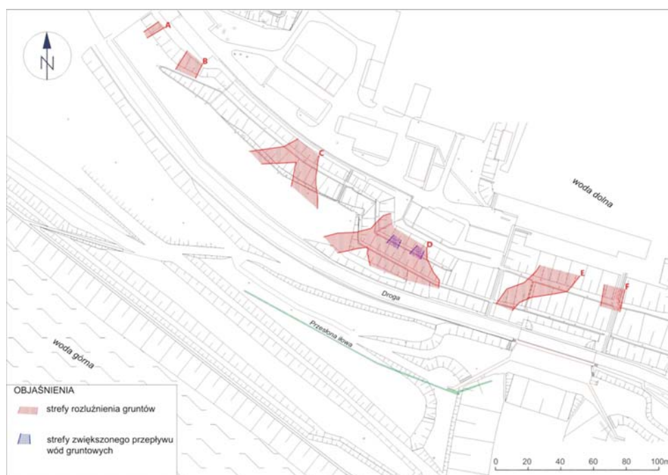
Rys. 8. Mapa lokalizacji stref rozluźnienia gruntów oraz zwiększonego przepływu wód gruntowych
