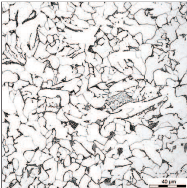
Rys. 14. Zdjęcie struktury uzyskanej w badanej próbce chłodzonej według wyników symulacji procesu chłodzenia blachy w kręgu
