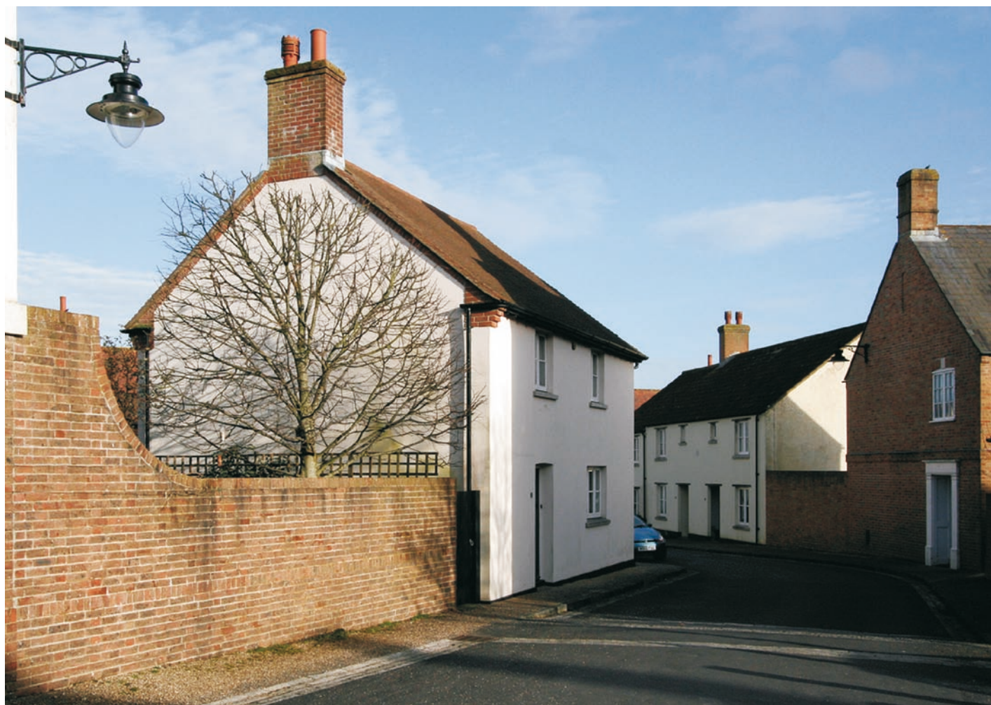
Ryc. 10. Poundbury, dzielnica Middle Farm. Stowcastle Street, widok w kierunku wschodnim. Zwraca uwagę skromna forma budynków oraz uproszczony detal architektoniczny. Na pierwszym planie widoczny skutek narzucenia obowiązku nasadzeń drzew o określonym stopniu dojrzałości. Widoczny wążek ceglany dopuszczalny na murach ogrodowych, który jest połączeniem wążków podstawowych ( Flemish Garden Wall bond ); źródło: Sandy Sorlien
