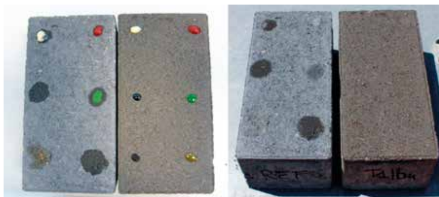
Fot. 3. Część lewa – po prawej kostka zabezpieczona MasterPel 500, po lewej bez zabezpieczenia; zabrudzenia kolejno od góry: majonez, ketchup, olej mineralny, zielony barwnik w oleju, kawa, oliwa z oliwek. Część prawa – po myciu myjką ciśnieniową; fot. BASF
