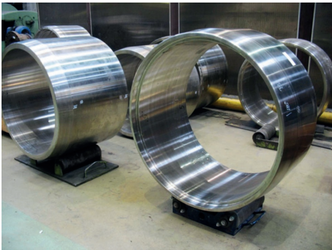
Rys. 31. Kołpaki wirników generatorów (paramagnetyki)
