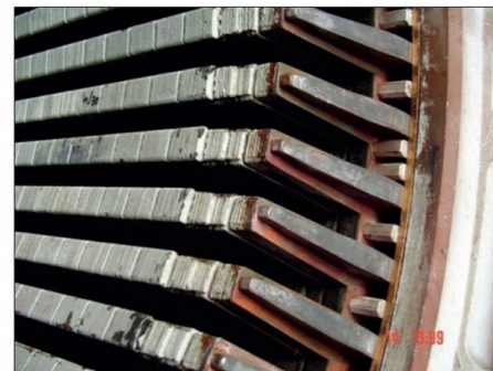
Rys. 28. Widok na pakiety skrajne stojana generatora i schemat lokalizacji
