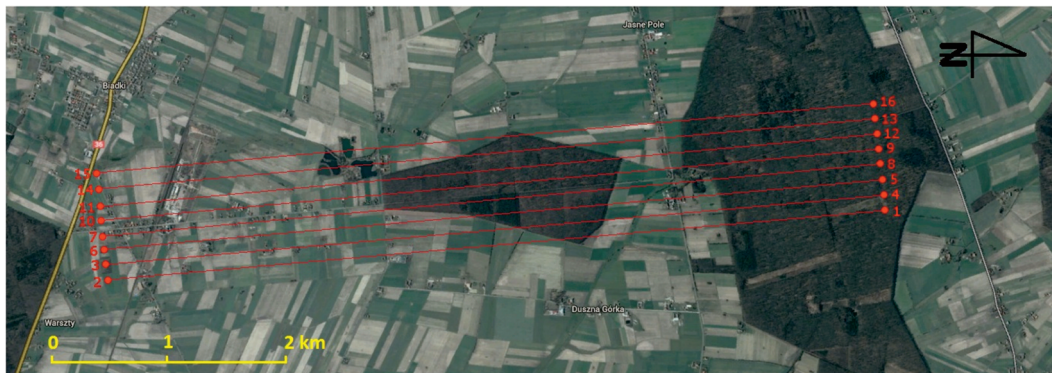
Rys. 2. Zobrazowanie szeregów wyznaczonych dla pokrycia fotogrametrycznego zaznaczonego obszaru leśnego [opracowanie własne]
