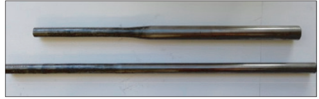
Fig. 4. The shape of the tube before and after drawing Rys. 4. Kształt rury przed i po ciągnięciu
