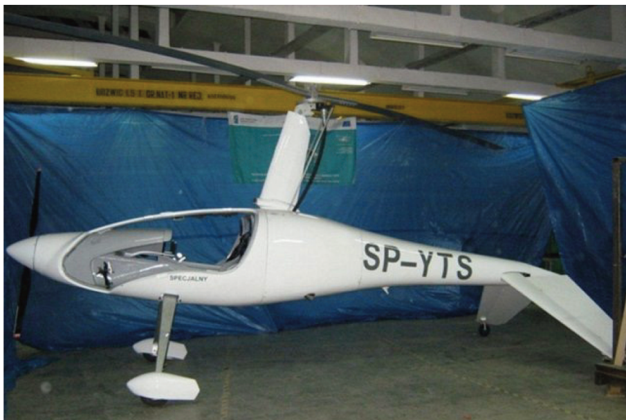
Rys. 5. Prototyp wiatrakowca I28 z zamontowanym podwoziem sprężystym (fot. mat. własne ILOT)
