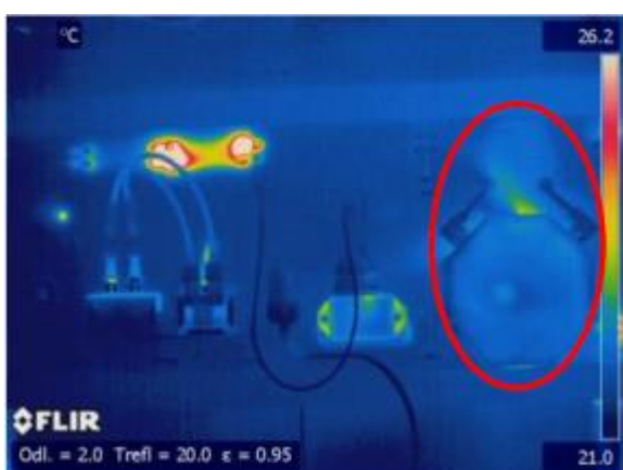
Rys. 4. Termogram monitorowanego układu zapłonowego wykonany po 130 s od rozpoczęcia pomiaru z wykorzystaniem ustawień automatycznych kamery [opracowanie własne]
