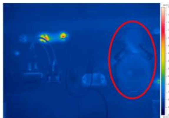
Rys. 5. Termogram monitorowanego układu zapłonowego wykonany po 130 s od rozpoczęcia pomiaru i po skorygowaniu rozpiętości temperatury [opracowanie własne]
