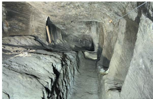
Rys. 3. Ślady po odpajaniu bloków soli (fot. A. Brzoza)
