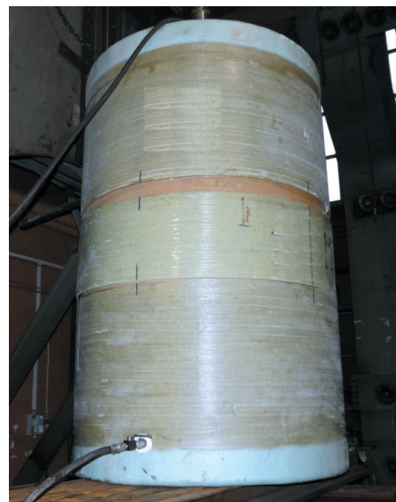
Rys. 7. Połączenie rur przeciskowych GRP DN 1300 w stanowisku badawczym
