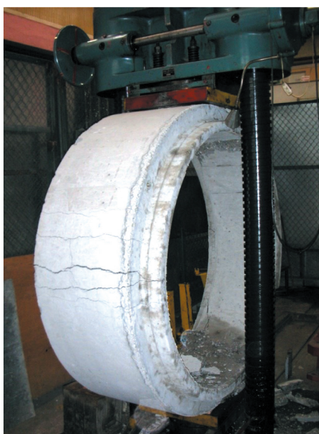
Rys. 12. Krąg żelbetowy o średnicy 1500 mm podczas próby zgniatania
