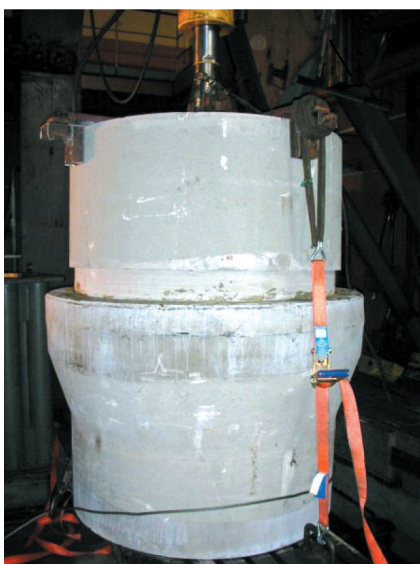
Rys. 6. Kielichowe połączenie rur żelbetowych DN 1000 w stanowisku badawczym
