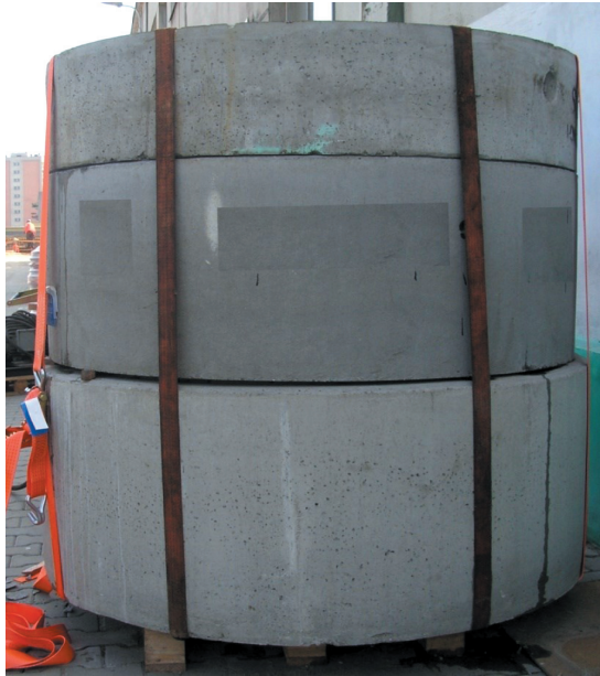
Rys. 8. Studzienka betonowa podczas badania
