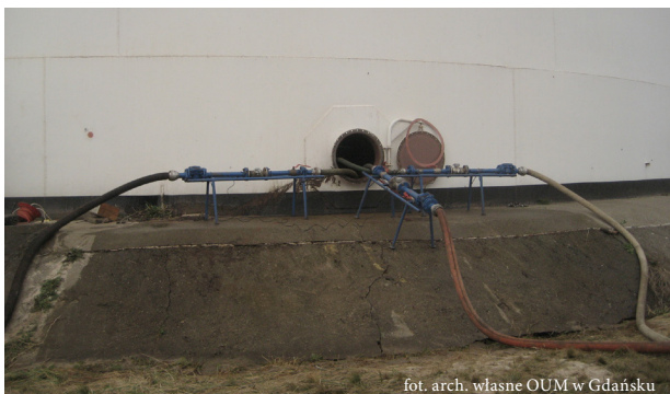
Fot. 3. Wzorcowanie zbiornika metodą objętościową
