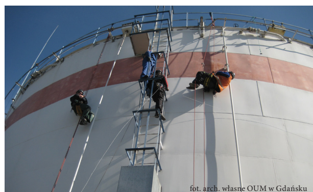
Fot. 1. Wzorcowanie zbiornika metodą geometryczną przy zastosowaniu metody opasania z użyciem przymiaru wstęgowego
