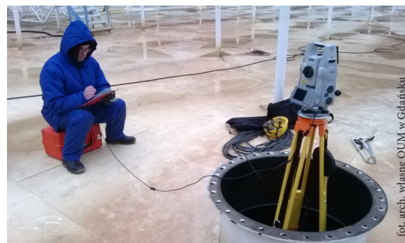
Rys. 8. Wzorcowanie zbiornika z dachem pływającym przy użyciu tachimetru
