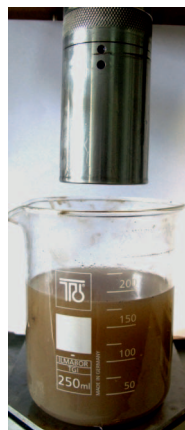
Fot. 15. Rotor viskozymetru po oddziaływaniu cieczy przemywającej nr 2 w systemie B
