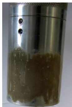
Fot. 2. Rotor viskozymetru po oddziaływaniu cieczy przemywającej nr 1
