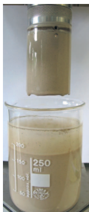
Fot. 14. Rotor viskozymetru po oddziaływaniu cieczy rozdzielającej o gęstości 1500 \text{ kg/m}^3
