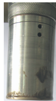
Fot. 8. Rotor wiskozymetru po oddziaływaniu mikroemulsji G
