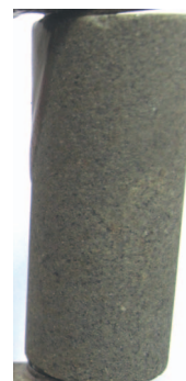
Fot. 19. Rdzeń piaskowca po przemyciu cieczą nr 3 w systemie A
