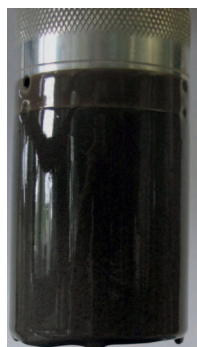
Fot. 5. Osad płuczkowy wytworzony na powierzchni rotora wiskozymetru
