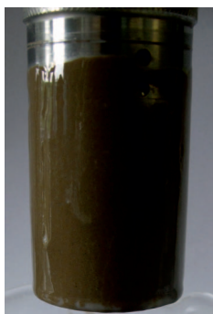
Fot. 1. Osad płuczkowy wytworzony na powierzchni rotora viskozymetru
