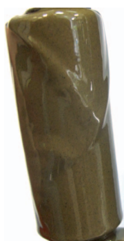
Fot. 20. Osad płuczkowy wytworzony na rdzeniu piaskowca w systemie B
