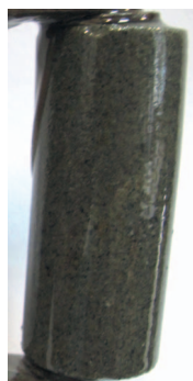
Fot. 18. Rdzeń piaskowca po przemyciu cieczą nr 2 w systemie A
