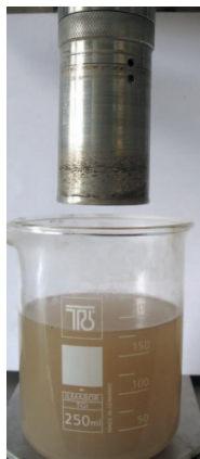
Fot. 10. Rotor viskozymetru po oddziaływaniu cieczy przemywającej nr 1
