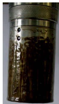
Fot. 7. Rotor wiskozymetru po oddziaływaniu mikroemulsji I
