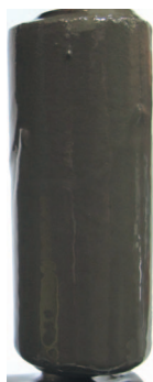
Fot. 16. Osad płuczkowy wytworzony na rdzeniu piaskowca
