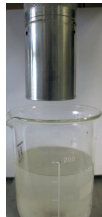
Fot. 12. Rotor viskozymetru po oddziaływaniu cieczy przemywającej nr 3
