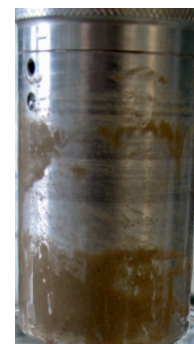
Fot. 4. Rotor viskozymetru po oddziaływaniu cieczy przemywającej nr 3
