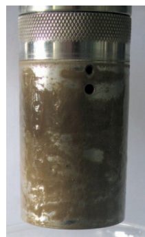
Fot. 3. Rotor viskozymetru po oddziaływaniu cieczy przemywającej nr 2
