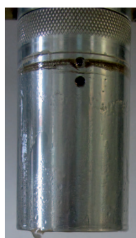
Fot. 6. Rotor wiskozymetru po oddziaływaniu mikroemulsji B
