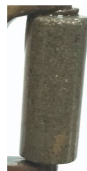
Fot. 22. Rdzeń piaskowca po przemyciu cieczą nr 2 w systemie B
