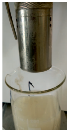
Fot. 11. Rotor viskozymetru po oddziaływaniu cieczy przemywającej nr 2 w systemie A
