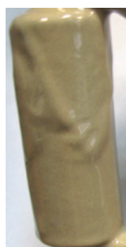
Fot. 21. Rdzeń piaskowca po przemyciu cieczą nr 1 w systemie B
