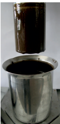
Fot. 13. Osad płuczkowy wytworzony na powierzchni rotora viskozymetru
