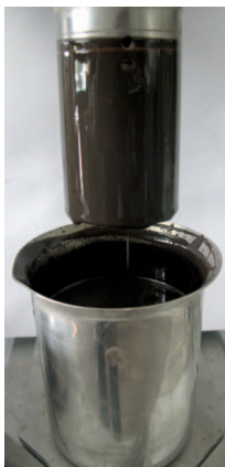
Fot. 9. Osad płuczkowy wytworzony na powierzchni rotora viskozymetru
