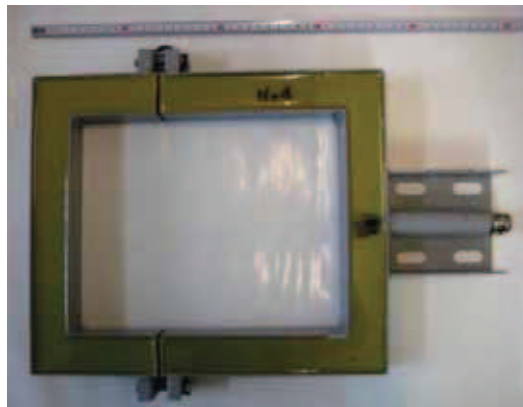
Rys. 9. Widok sprzęgacza typu SS2-80 (opracowanie własne)
