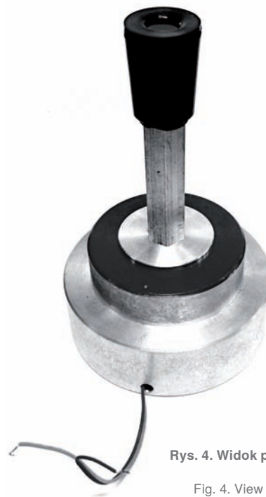
Rys. 3. Model triangulacyjnej głowicy pomiarowej z uchwytem Fig. 3. The model of triangulation measurement head with handle
