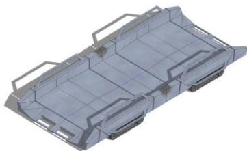
Rys. 1. Koncepcja pojazdu PRWL, kształt i elementy modelu funkcjonalnego, przeznaczonego do prowadzenia akcji ratunkowej na akwenach pokrytych lodem [źródło: M.K. Gerigk, 2014-2015].
