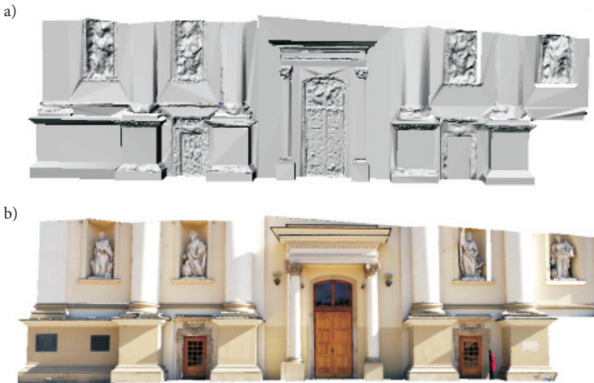
Rys. 4. Model 3D fasady kościoła św. Anny w Warszawie w formacie TIN: a) bez tekstury; b) z nałożoną teksturą
