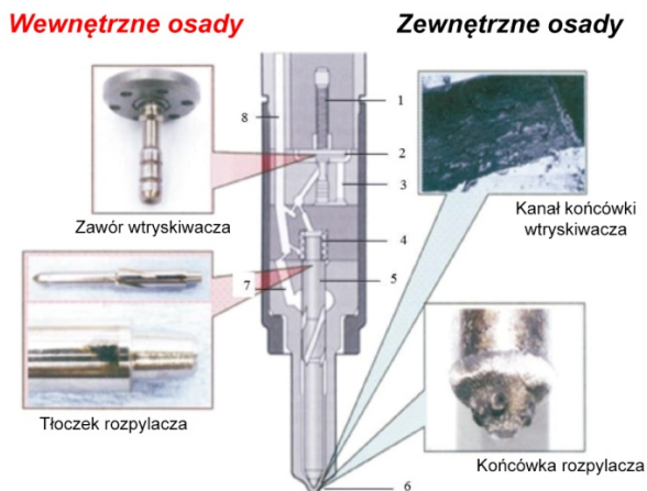
Rys. 1. Przekrój wtryskiwacza i miejsca występowania osadów zewnętrznych i wewnętrznych: 1 – sprężyna zaworu elektromagnetycznego, 2 – zawór sterujący, 3 – kanał odpływowy paliwa, 4 – komora sterowania rozdziałem paliwa, 5 – iglica rozpylacza, 6 – otwór rozpylacza, 7 – komora wstępna, 8 – kanał paliwowy [7]
