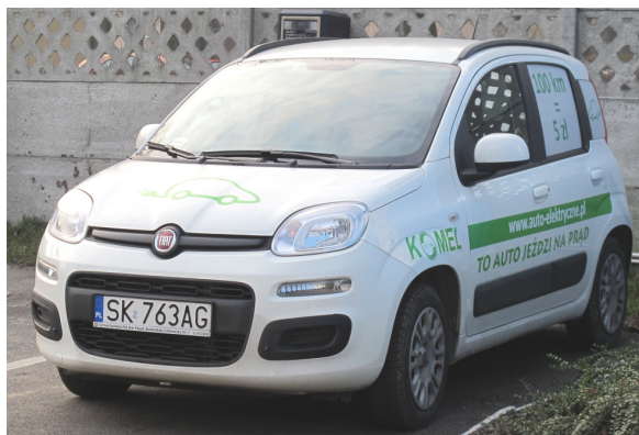
Rys. 1. Samochód Fiat Panda III zelektryfikowany w zestawie E-Kit
