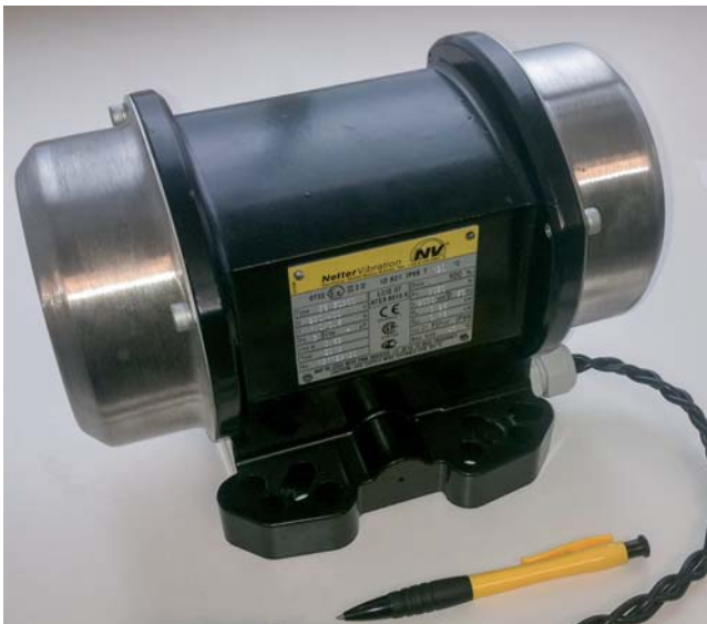
Fig. 1. Shaker unit used for the prototype construction Rys. 1. Zastosowany szejker przemysłowy
