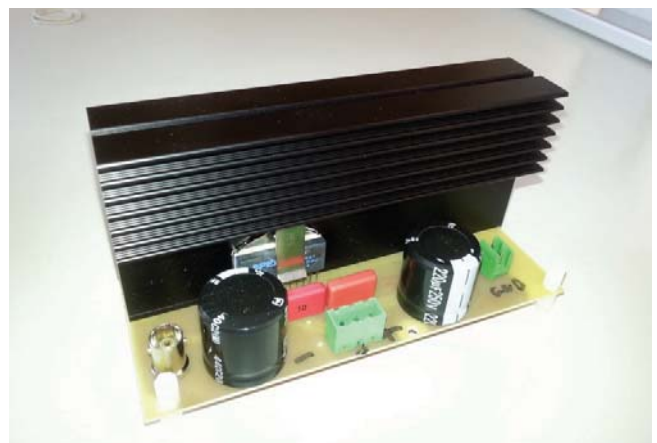
Fig. 4. Prototype of the shear force transducer power control module Rys. 4. Prototyp wzmacniacza dla przetworników siły
