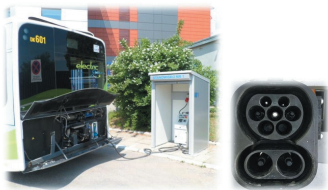
Fot. 1. Złącze plug-in w autobusie elektrycznym Źródło: Zasoby własne MPK SA w Krakowie
