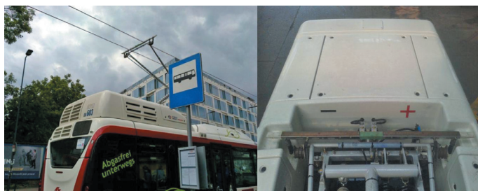
Fot. 5. Stanowisko ładowania autobusu Rampinii „sposobem wiedeńskim” Źródło: Zasoby własne MPK SA w Krakowie
