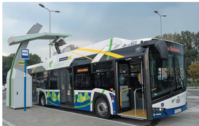
Fot. 8. Szybkie ładowanie autobusu Solaris U12 Electric metodą Schunka na pętli autobusowej Osiedle Podwawelskie
