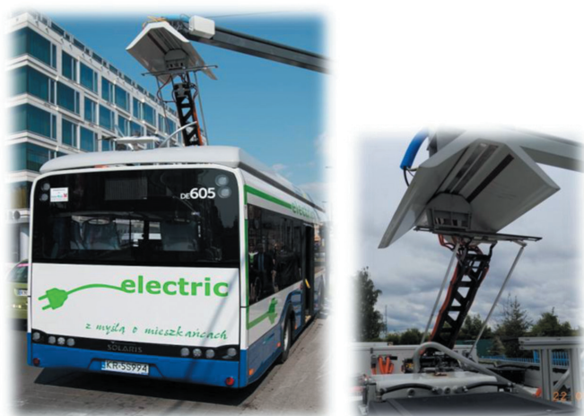
Fot. 2. Złącze pantografowe typu Schunk w autobusie elektrycznym Źródło: Zasoby własne MPK SA w Krakowie
