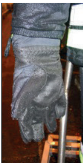
Rys. 4. Zamocowanie rękawicy na stanowisku badawczym
