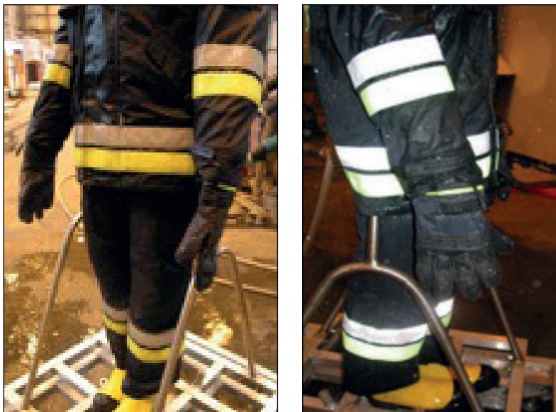
Rys. 2, 3. Zamocowanie rękawicy na stanowisku badawczym
