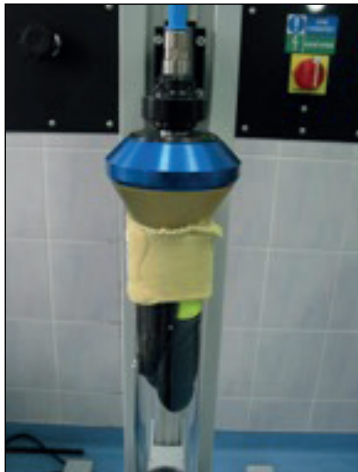
Rys. 6. Widok rękawicy uszczelnionej silikonowym stożkiem
