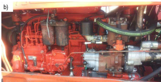
Rys. 5. Rozrusznik spalinowy (pomocniczym silnikiem): a) widok silnika rozruchowego DT75 KPL PD 10 [13], b) przykład zastosowania silnika rozruchowego [14]
