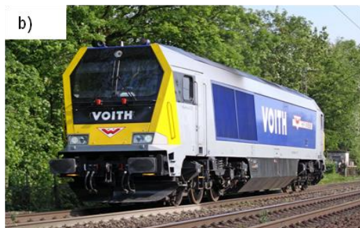
Rys. 4. Widok lokomotyw wyposażonych w rozruch pneumatyczny: a) lokomotywa EMD SD70Ace, fot. D. Hawkins [8], b) lokomotywa Voith Maxima, fot. D. Meyer [4]
