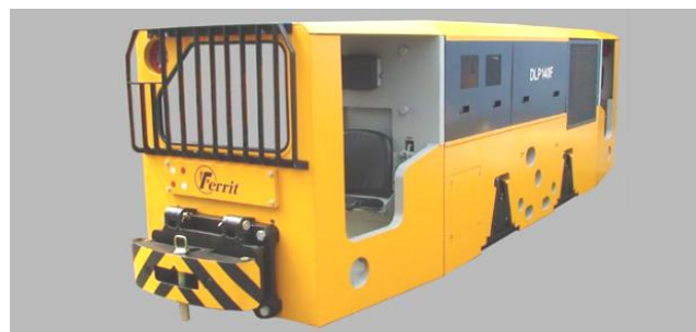
Rys. 7. Widok lokomotywy przemysłowej typu DLP140F stosowanej w kopalniach węgla kamiennego [12]
