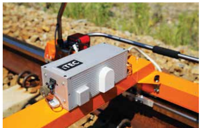
Rys. 2. Moduł inercyjny toromierza iTEC [1]
