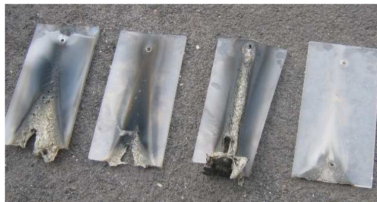
Fot 8 i 9 Test gaśniczy z polietylenem.
