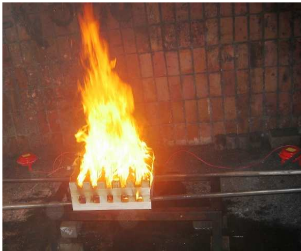
Fot 6 i 7 Test gaśniczy ze stosem drewna.
