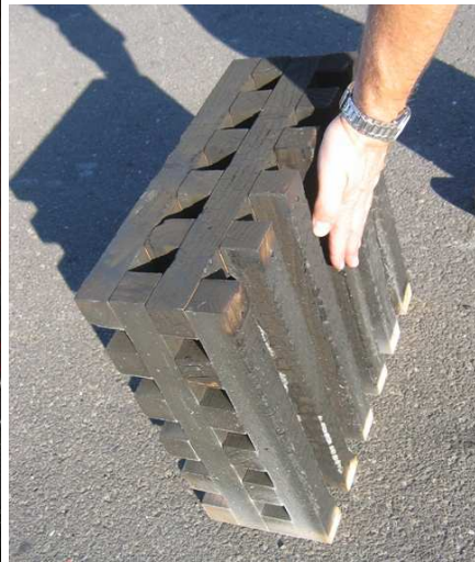
Fot 6 i 7 Test gaśniczy ze stosem drewna.
