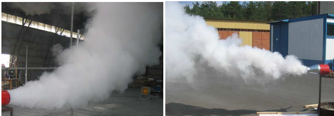
Fot. 1 i 2 Strumień aerolu podczas rozładowania na hali i na wolnym powietrzu.
