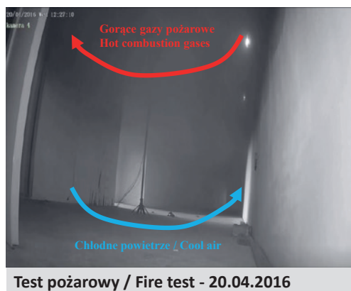
Rycina 12. Przepływ powietrza i dymu na korytarzu łączącym pomieszczenie objęte pożarem przy otwartych drzwiach na klatkę schodową i działaniu nawiewu kompensacyjnego
