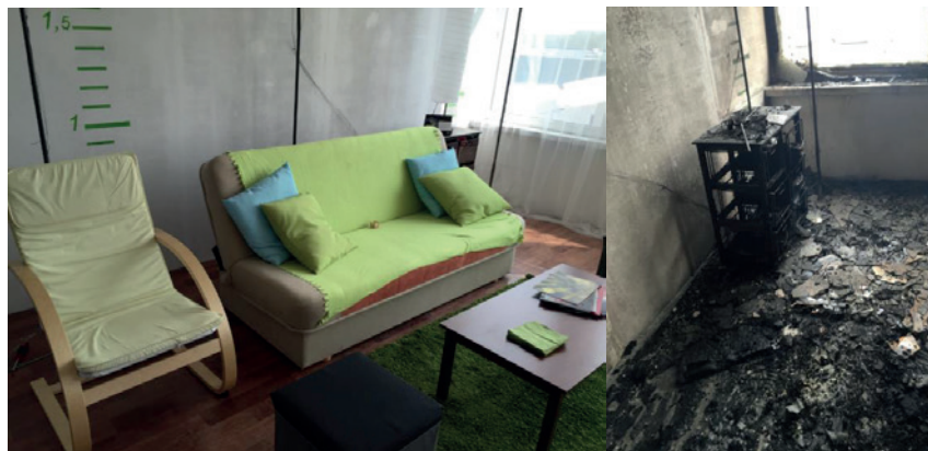
Rycina 3. Skutki pożaru swobodnie rozwijającego się w pomieszczenia testowym
