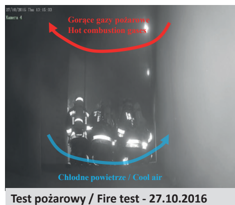
Rycina 12. Przepływ powietrza i dymu na korytarzu łączącym pomieszczenie objęte pożarem przy otwartych drzwiach na klatkę schodową i działaniu nawiewu kompensacyjnego
