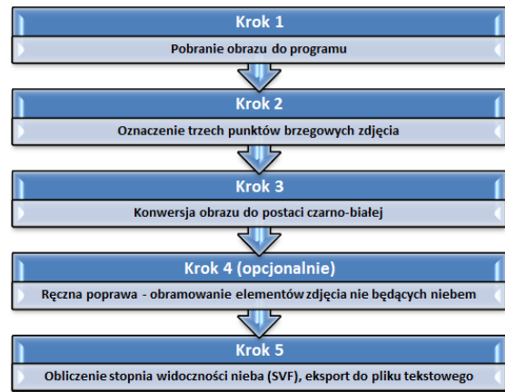
Rys.1. Algorytm postępowania w programie SVF Calculator
