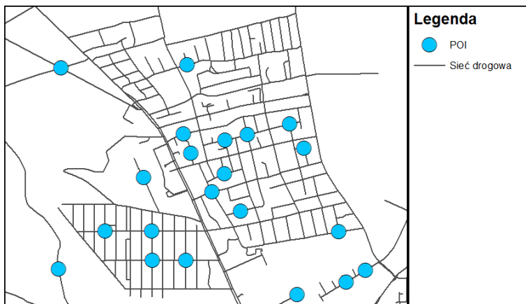
Rysunek 5. Rzutowanie POI na sieć drogową
