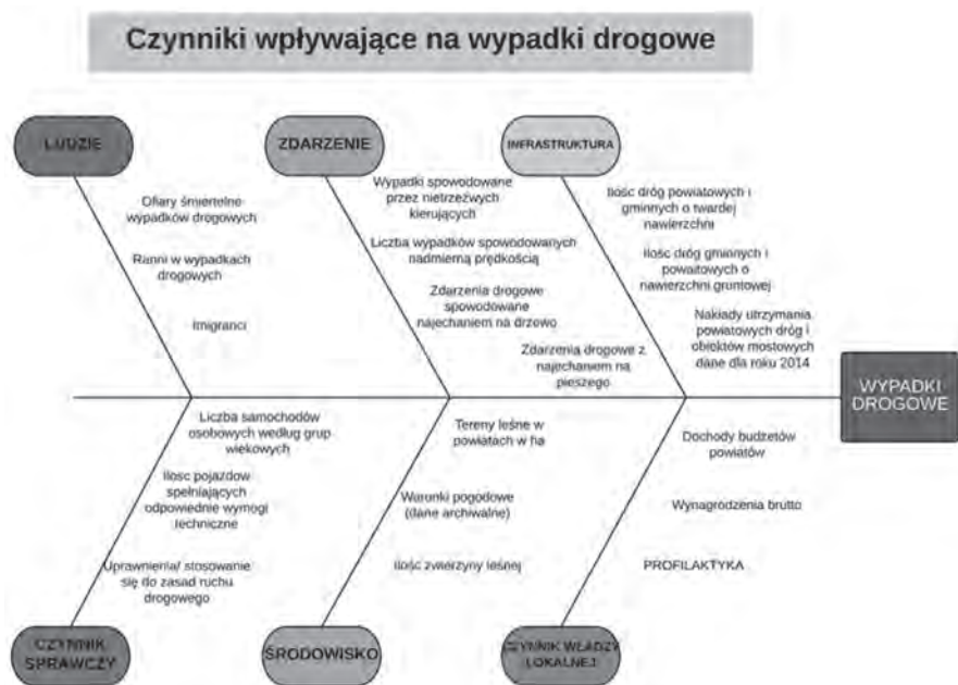
Rys. 2. Wybrane czynniki wpływające na wypadki drogowe przedstawione na diagramie Ishikawy
